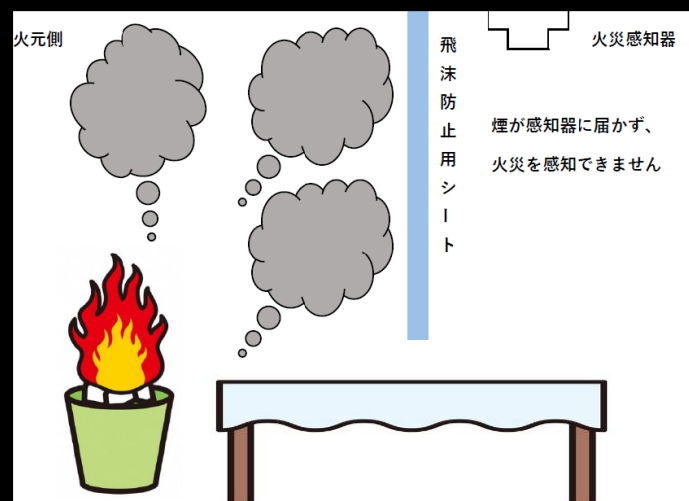
火災報知器未警戒部分が生じる例
