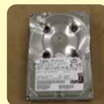
ハードディスクの破壊(穴あけ)例
