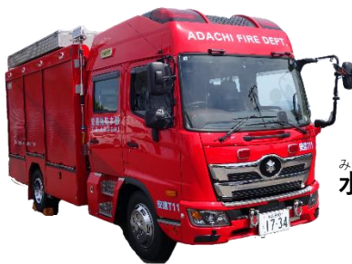
タンク車 (2台) (水そう付きポンプ車)
