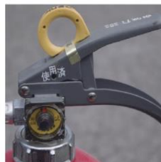
× 表示装置の脱落
