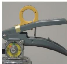
× レバー支えの脱落
