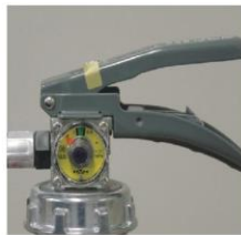
× 安全栓の脱落
