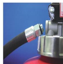
× 緊結ネジの破損 × ホースの脱落
