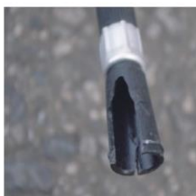
× ノズルの破損
