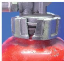
× キャップの破損
