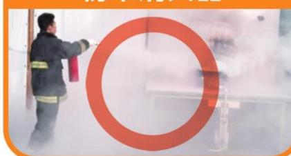
窒息効果で消火するので、再発火の可能性があります。消火器に充填された薬剤を最後まで放射してください。
